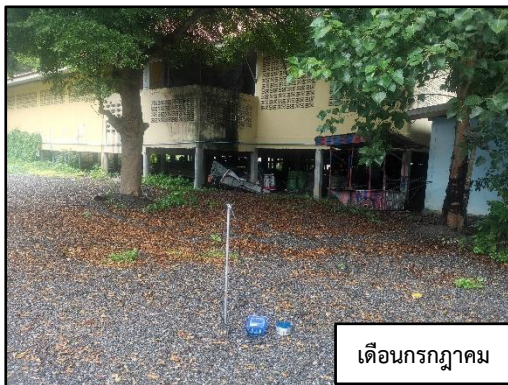
ภาพที่ 3.11 การตรวจวัดความสั่นสะเทือนจากการระเบิดหิน บริเวณชุมชนบ้านชะอมตะวันออก
